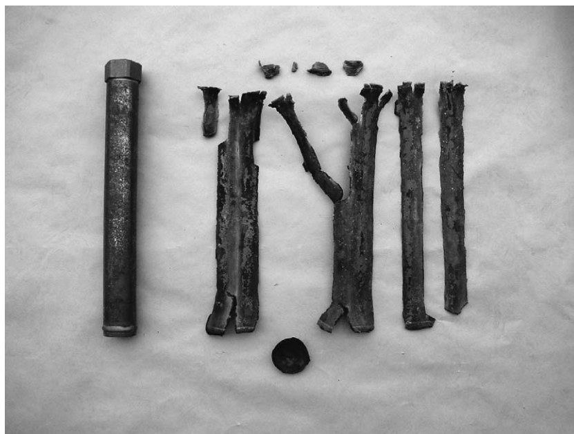
Fig. 6. HOBt: dry, detonation test (UN test A.1).
